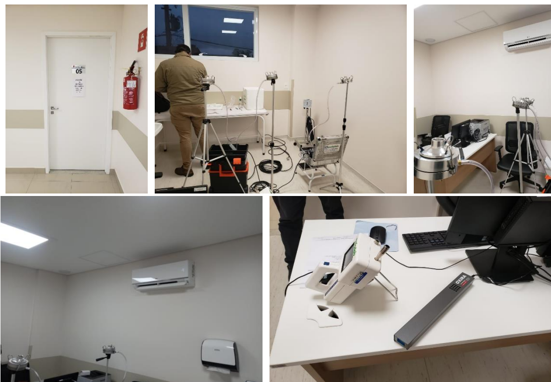
Figura 2: Disposição dos equipamentos de amostragem de bactérias no ar.
